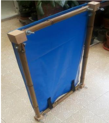
Imagen 12. Cara lateral del módulo con su cerramiento
