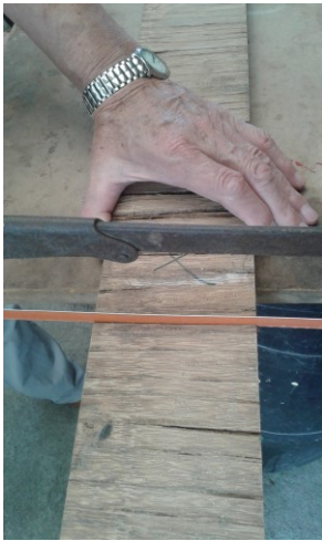
corte caja de interseccion
