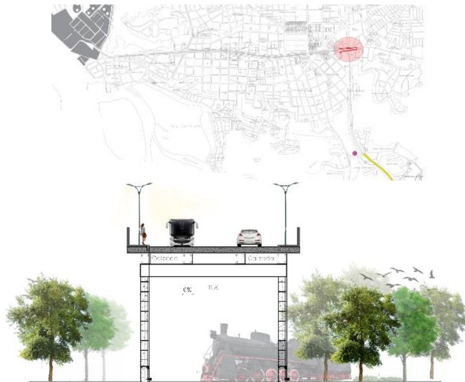
Figura 24 Perfil vial existente de la calle 52.
