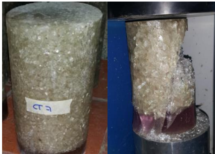
Figura 6. Probetas de CT sin alterar y tipo de fallamiento
