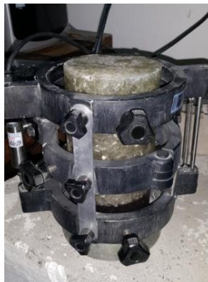
Figura 4. Deformímetros horizontal y vertical para medir los módulos de Poisson Fuente: autores.
