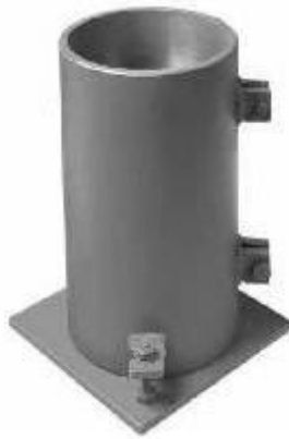
Figura 3. camisa para fundición de concreto de 4 pulgadas de diámetro y altura de 8 pulgadas.
