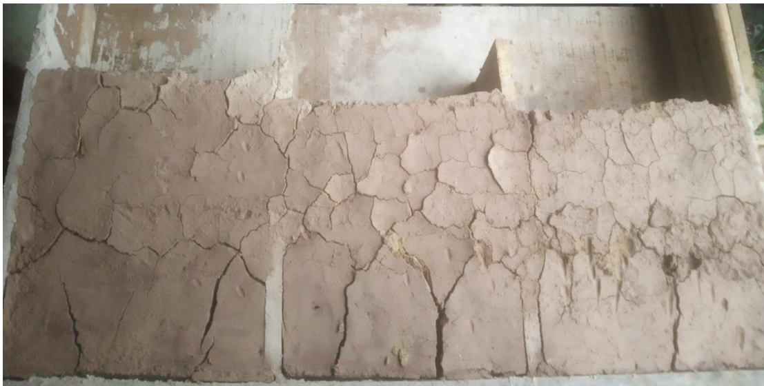
Figura 10. Distribución de murete con pintura comercial a la izq. Centro sin pintura y der. Con pintura ecológica. Elaboración propia.
