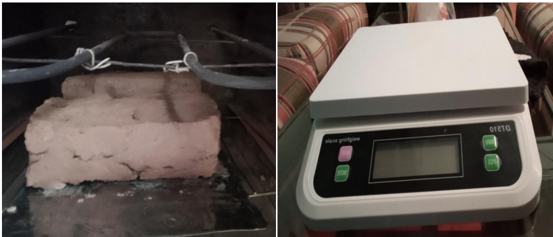
Figura 21. Bloques de tapia pisada secados en horno durante 4 hrs hasta lograr obtención total de peso seco y balanza de precisión para ensayos. Elaboración propia.
