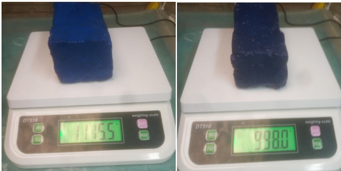
Figura 25. Bloques son pesados para determinar porcentaje de humedad después de ser intervenidos en agua. Elaboración propia.
