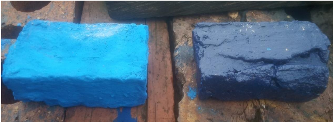
Figura 22. Bloques de tapia pisada pintados con pintura comercial y ecológica listos para ser pesados y puestos a ensayo. Elaboración propia.
