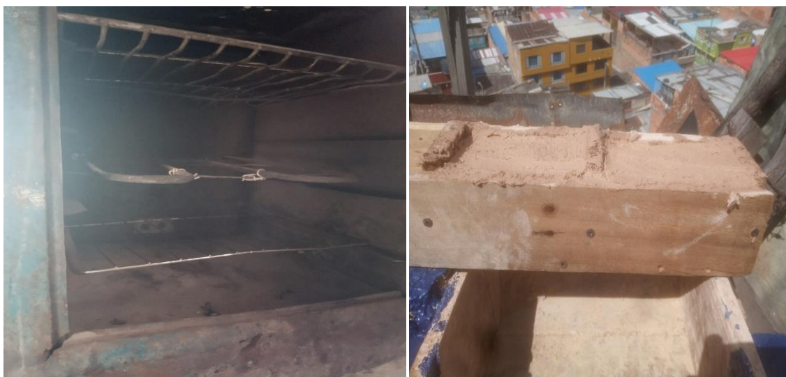
Figura 20. Horno de secado y muestras de tierra apisonada encofradas. Elaboración propia.
