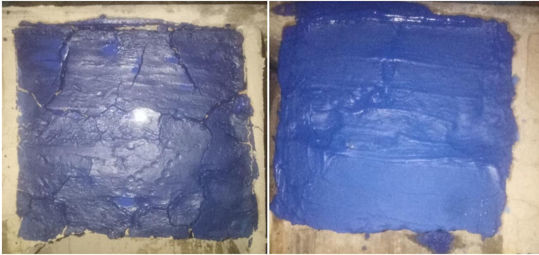
Figura 12. A la izquierda pintura impermeabilizante comercial a la derecha pintura ecológica impermeabilizante a base de cal y sábila. Elaboración propia.
