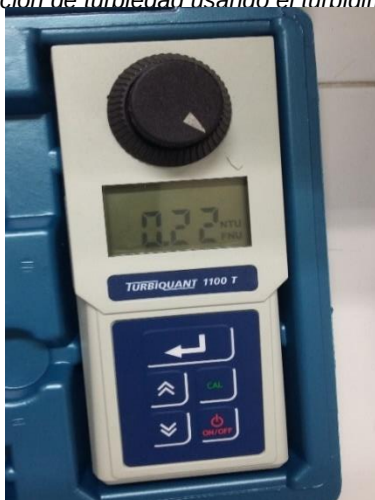
Fotografía 35. Medición de turbiedad usando el turbidímetro (muestra 5)
