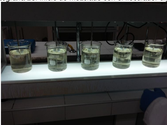
Fotografía 28. Inicio de mezclado con el floculador digital
