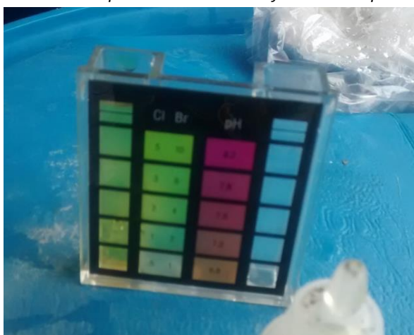
Fotografía 23. Tester manual para medición de PH y Cloro en el proceso de desinfección
