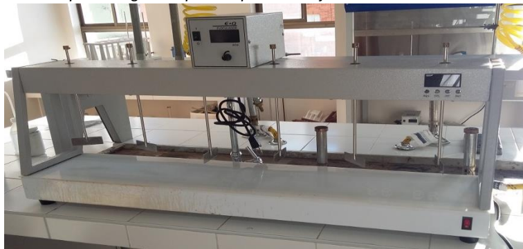
Fotografía 24. Aparato agitador para la prueba de jarras con iluminación en la base
