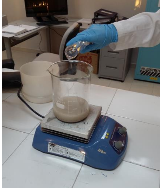
Fotografía 27. Mezcla de agua destilada y coagulante
