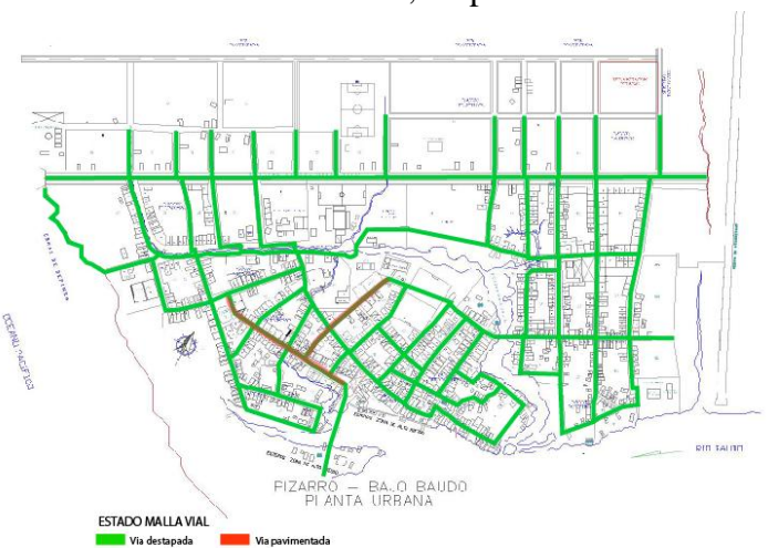
Ilustración 13 Estado de malla vial. Fuente: Elaboración propia.
