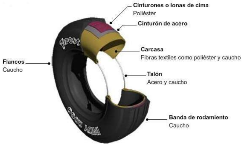
Ilustración 18 Materiales de la llanta
