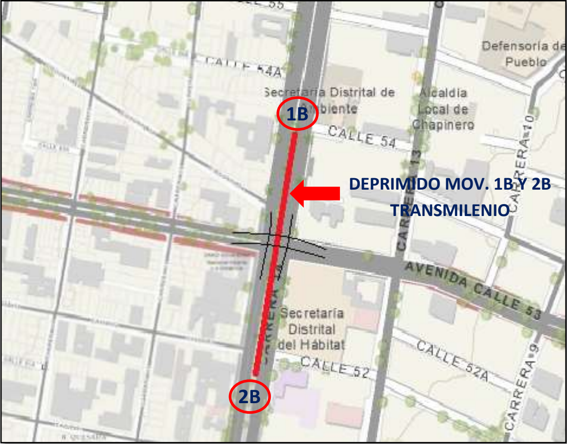
Figura 24. Deprimido exclusivo para carril de Transmilenio
