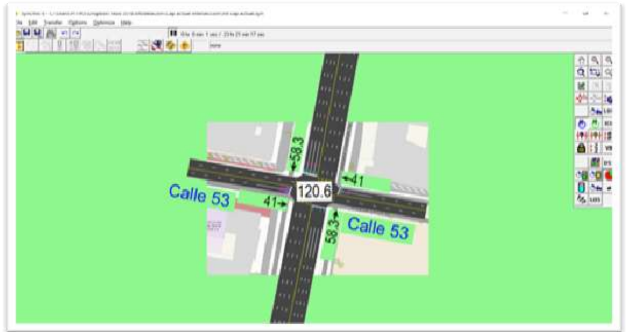
Figura 27. Tiempos semafóricos en la intersección actualmente.
