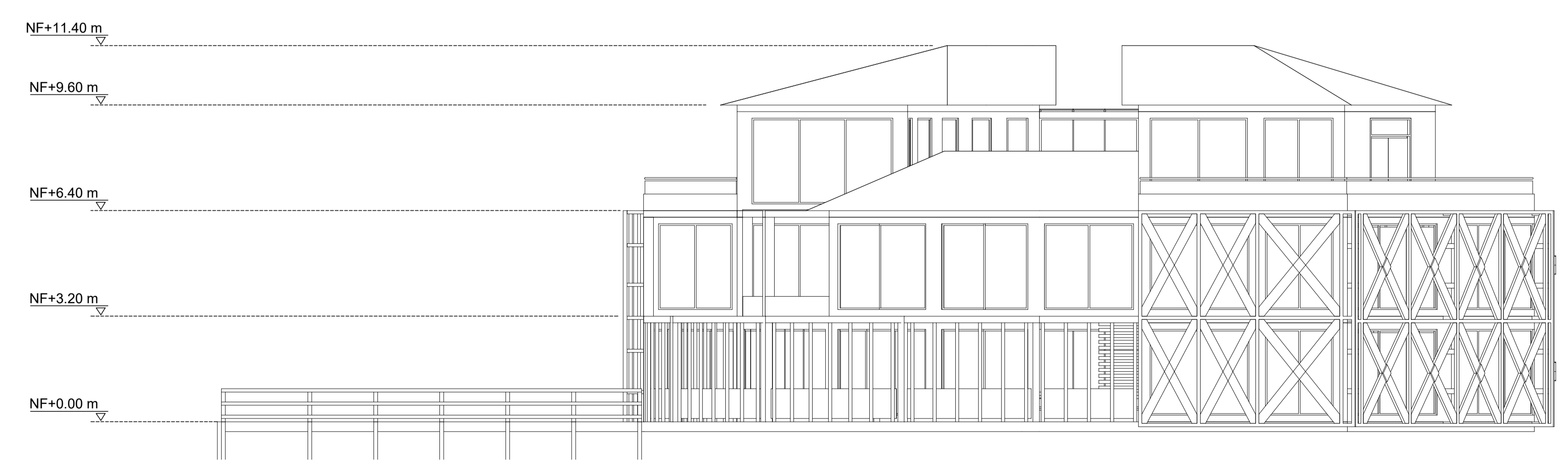
F2 FACHADA LATERAL IZQUIERDA ESC. 1 : 100
