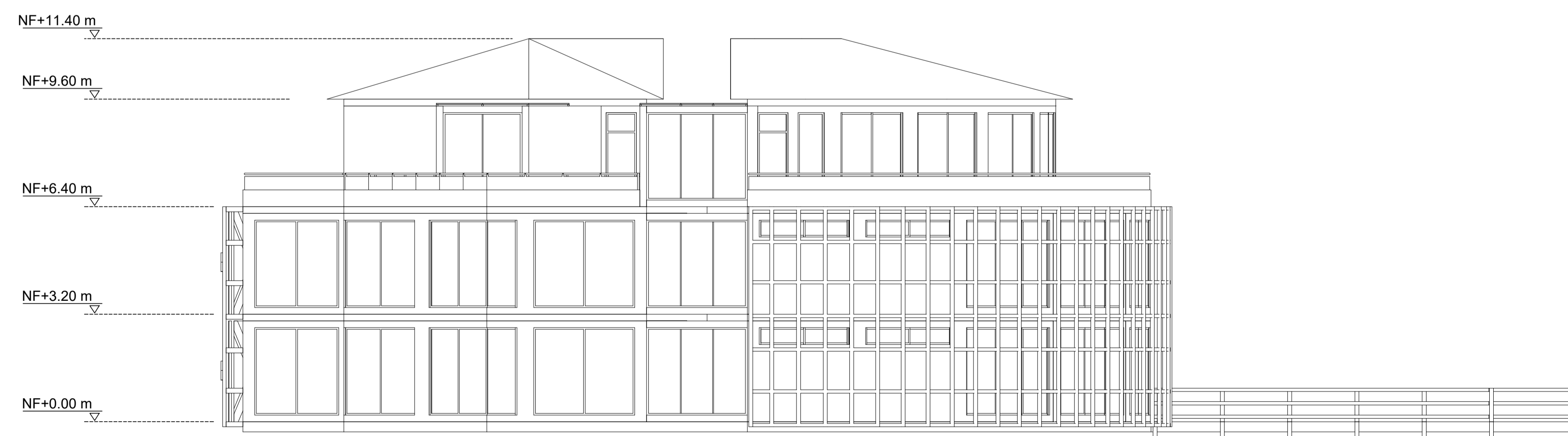
F4 FACHADA LATERAL DERECHA ESC. 1 : 100
