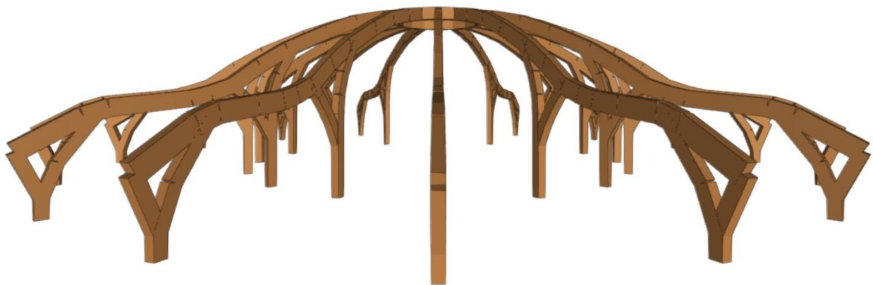
Estructura de madera laminada
