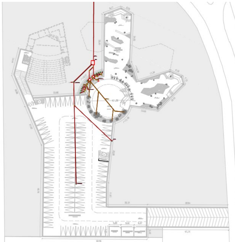
Figura 65: Red de desagües, planteamiento proyecto vista desde el cuarto nivel. Elaboración propia.
