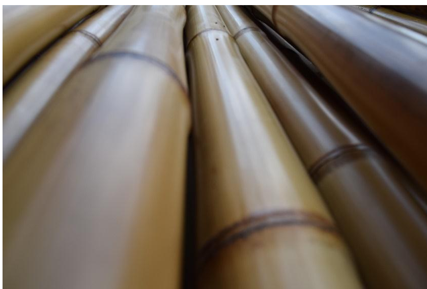
Imagen 62 Acabado en elementos de Guadua sometidos a altas temperaturas.
