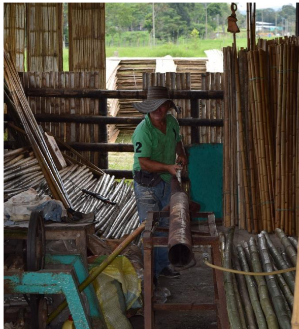
Imagen 61 Inmunización por alta temperatura.
