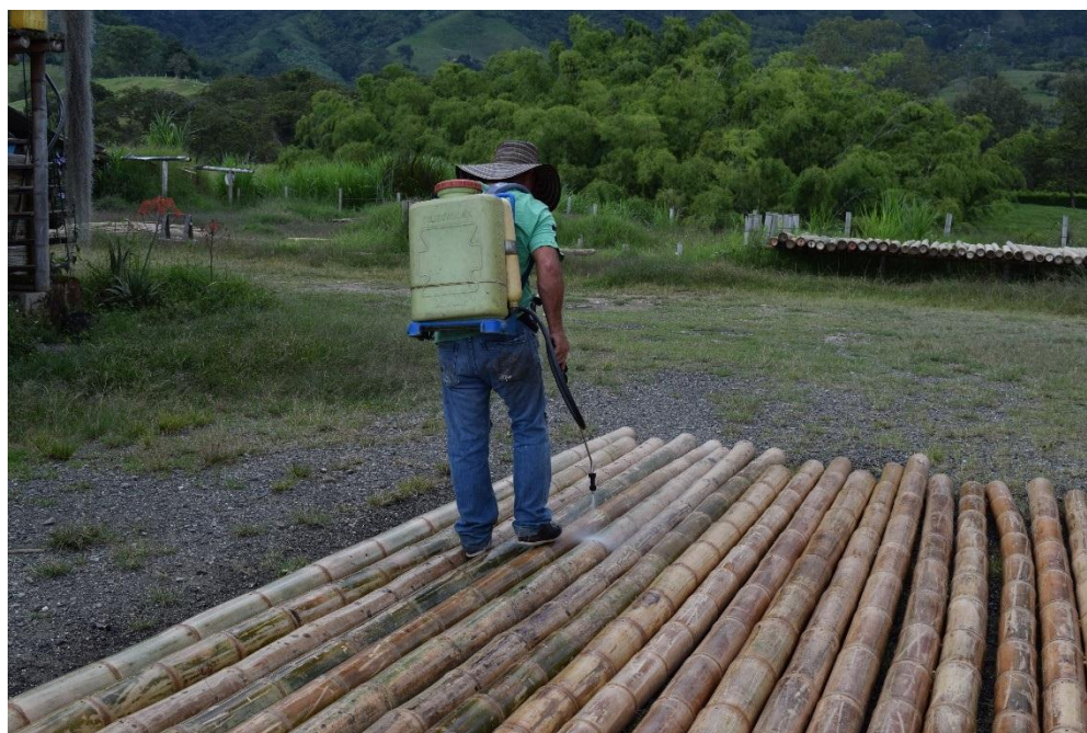
Imagen 58 Inmunización de Gauduas con solución de "Inmunizante NV"
