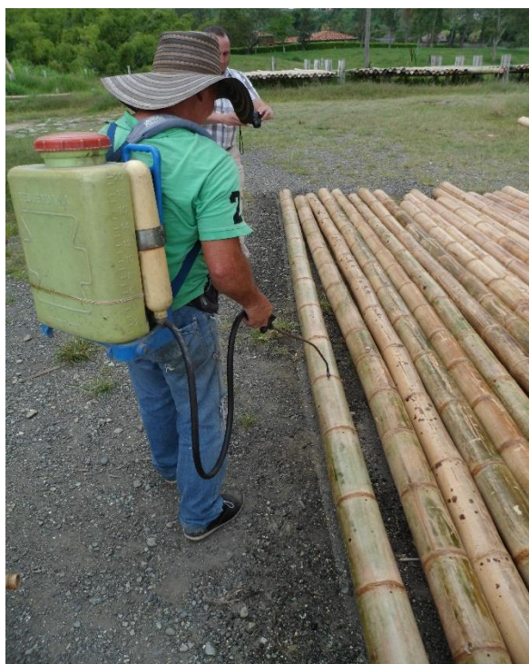
Imagen 3 Preservación por inyección.
