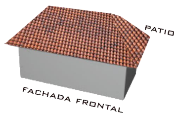
Imagen 14. Tipología de crujía frontal. Construcción propia.
