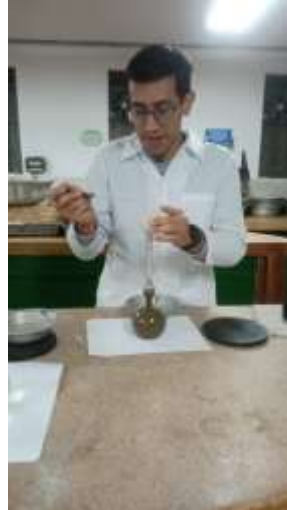
Imagen 51. Se introduce muestra de polvillo de hueso (cemento) en el frasco de Chatelier. Fuente: propia.
