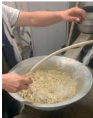
Imagen 35. Muestra de agregado sumergible en agua durante 24 h para saturar los poros. Fuente: propia.
