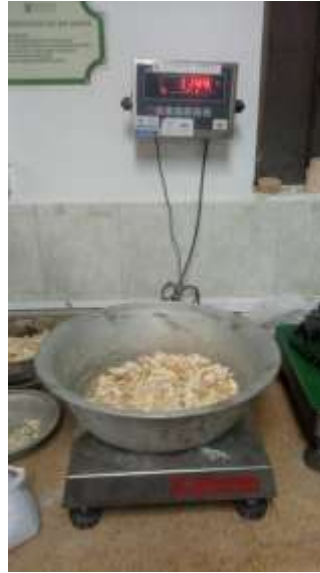
Imagen 56. Cantidad de Agregado grueso (hueso triturado) para el diseño de mezcla. Fuente: propia.
