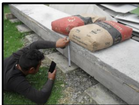
Fig.31: Carga de cemento de 50kg cada uno para verificar que cantidad de peso soporta el entrepiso. Fuente: Elaboración propia (2017).
