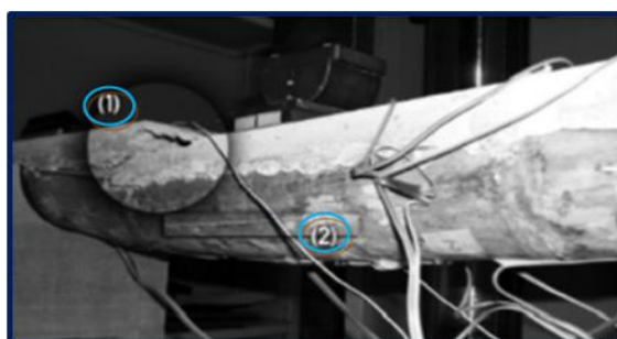
Fig. 3. Indica falla de corte en la capa de concreto mientras (2) muestra grietas en caña de bambú.
