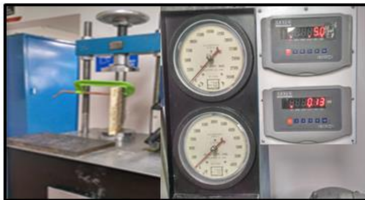
Fig.21: Montaje de prototipo a compresión Fuente: Elaboración propia (2017).
