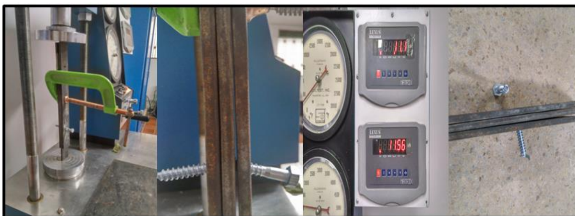
Fig.25: Detalle de falla en conector de 11.1 KN en el corte completo del conector. Fuente: Elaboración propia (2017).
