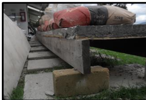
Fig.33: Deformación en entrepiso con un peso de 600Kg Fuente: Elaboración propia (2017).
