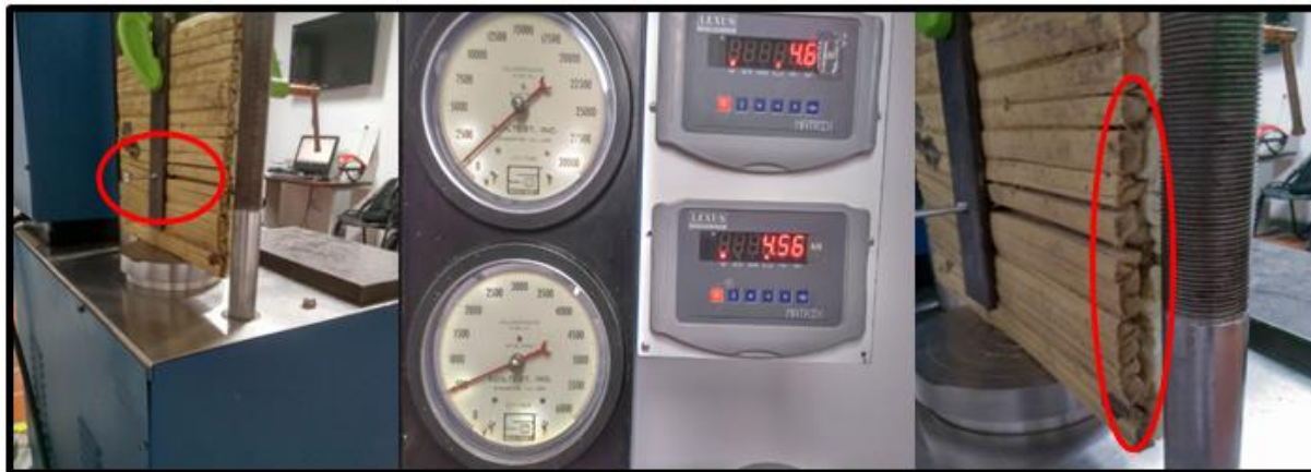
Fig.22: Montaje de prototipo a compresión lamina transversal, con falla en adherencia de guadua laminada. Fuente: Elaboración propia (2017).
