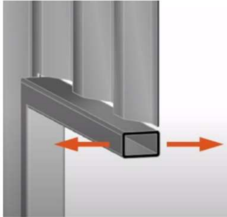
Figura 22. Detalle reforzamiento dintel - Elaboración propia
