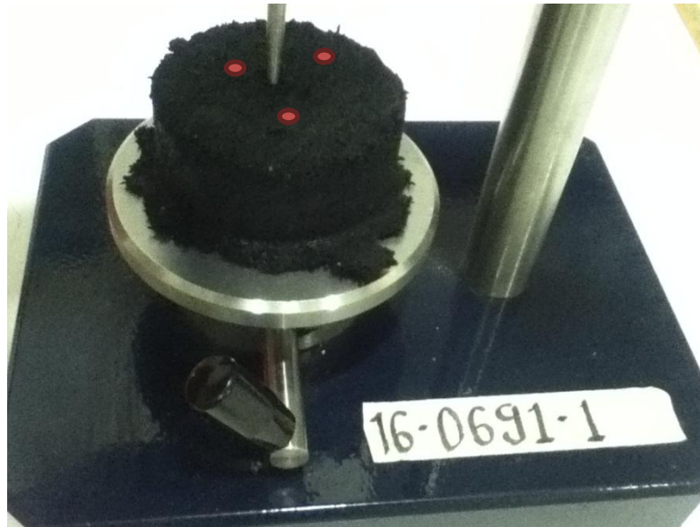
Figura 18 Posiciones de lecturas del penetrómetro
