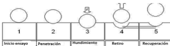
Figura 27 Proceso de recuperación de la probeta
