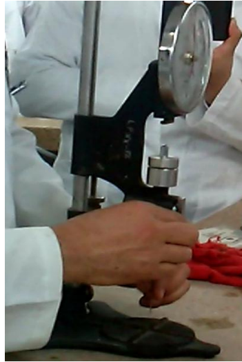
Figura 16. Ajuste de la guja del penetrómetro
