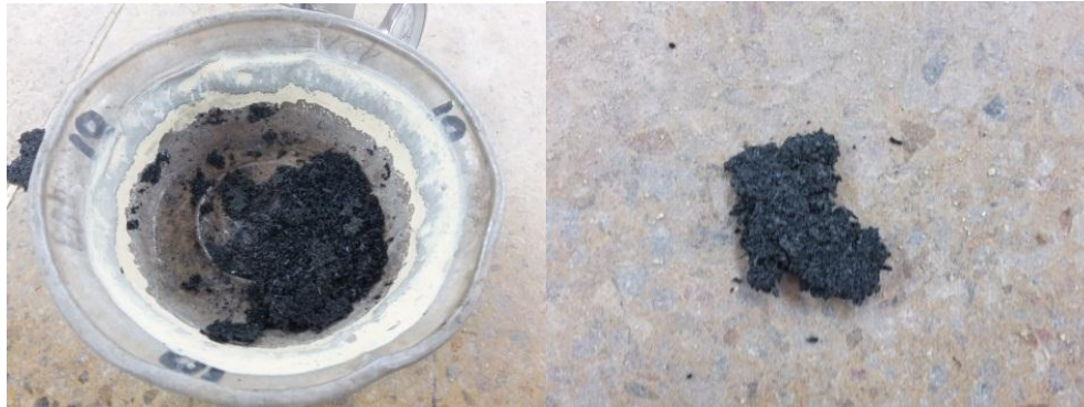
Figura 15. Cristalización en el proceso de desvulcanización
