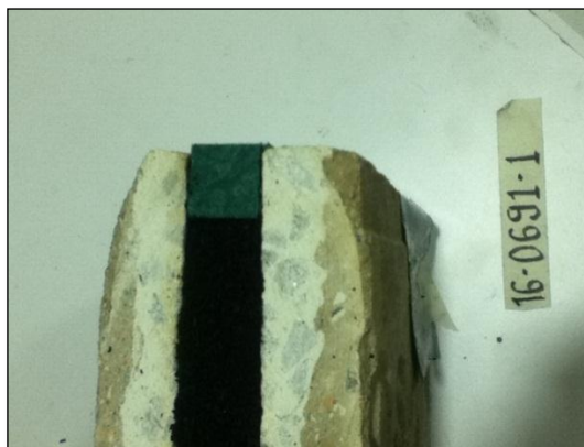
Figura 23 Probeta ensayada en la máquina de tensión
