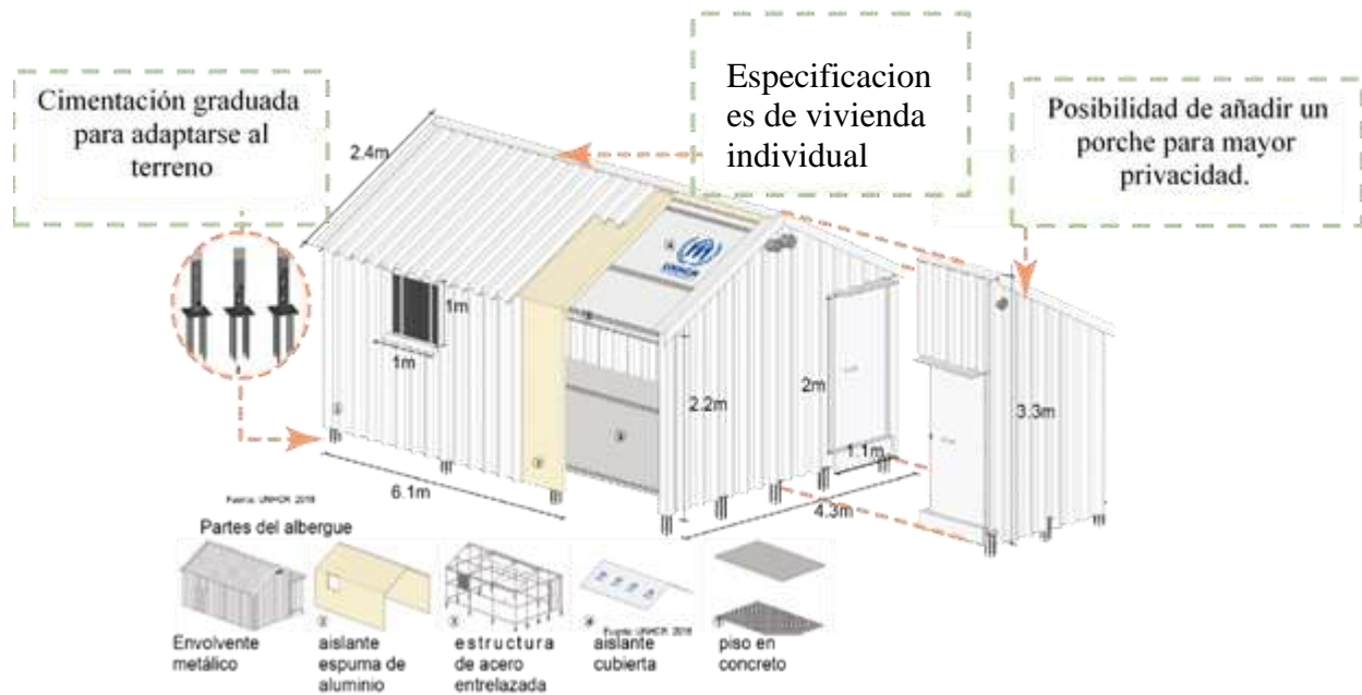
Figura 12. Elementos tecnológicos y constructivos. Tomada de: “shelter design catalogue” (2016) UNHCR. Recuperada de https://bit.ly/2Xc7jJV
