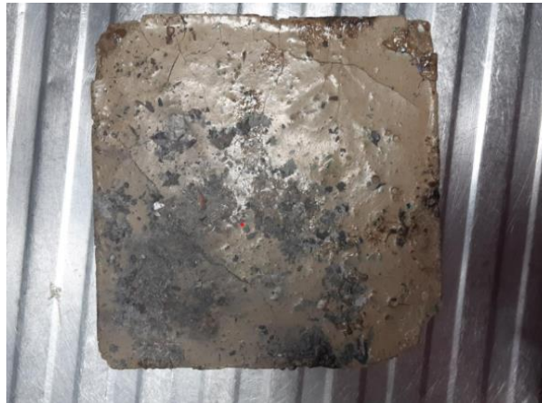
Figura 31 Tableta después de estar expuesta al fuego. Elaboración propia
