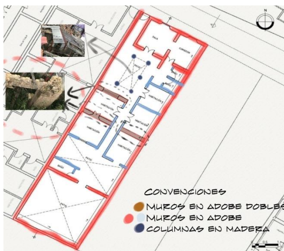
Planimetría Original del inmueble Gommel- Distribución estructural
