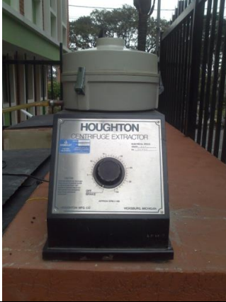
Foto 23: RAP caliente a 60°C con gasolina (500ml) en el recipiente de la extractora.
