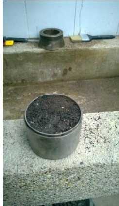
Foto 39: enfriamiento de la muestra
