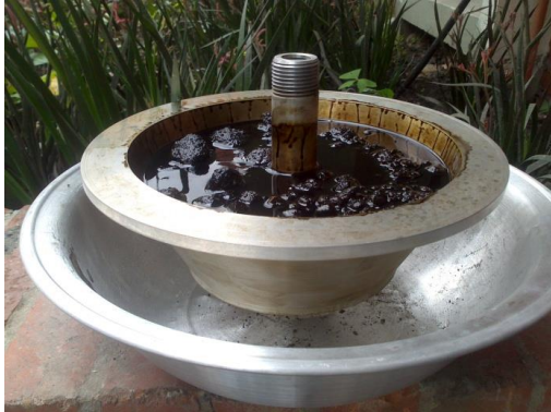
Foto 23: RAP caliente a 60°C con gasolina (500ml) en el recipiente de la extractora.
