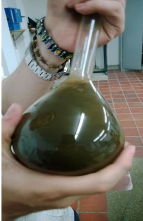
Foto 29: eliminación de las burbujas de aire.
