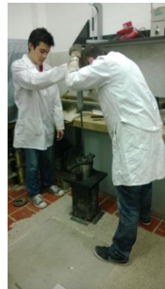
Foto 38: compactación final de la briqueta
