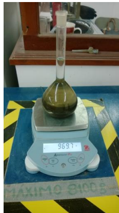
Foto 30: peso final de la muestra con picnómetro y agua.
