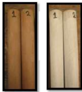
Figura 3. Prueba de impermeabilización la cual consistió en aplicar cada producto a un juego de tubos y dejar secar por un periodo de dos (2) horas. Tomada de: Fernández y Hernández (2016). Muros en tubos de cartón rellenos se aserrín como aislantes térmicos para climas fríos (Tesis de tecnología). Universidad la Gran Colombia, Bogotá D.C. Recuperado de https://repository.ugc.edu.co/bitstream/handle/11396/4020/Proyecto%20Muros%20en%20Tubos%20de%20Carton%20Rellenos%20de%20Aserr%c3%adn.pdf?sequence=1&isAllowed=y .
