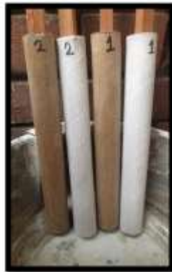
Figura 4. Prueba de impermeabilización en este paso se ubicaron los tubos en sentido vertical sumergiéndolos en agua durante 48 horas, debidamente sellados por uno de sus extremos para evitar que el agua se filtre en la parte que se encuentra expuesta a la humedad. Tomada de: Fernández y Hernández (2016). Muros en tubos de cartón rellenos se aserrín como aislantes térmicos para climas fríos (Tesis de tecnología). Universidad la Gran Colombia, Bogotá D.C. Recuperado de https://repository.ugc.edu.co/bitstream/handle/11396/4020/Proyecto%20Muros%20en%20Tubos%20de%20Carton%20Rellenos%20de%20Aserr%c3%adn.pdf?sequence=1&isAllowed=y .
