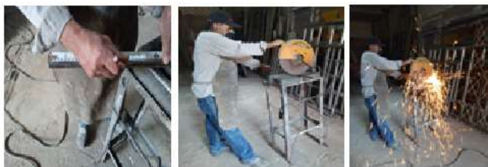
Figura 28. Proceso de corte de las piezas en acero.
