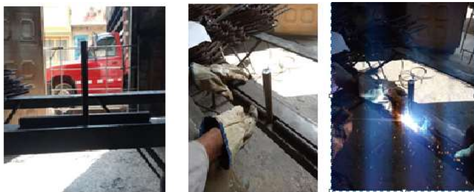
Figura 27. Proceso de soldadura de las piezas en acero. Elaboración propia.
