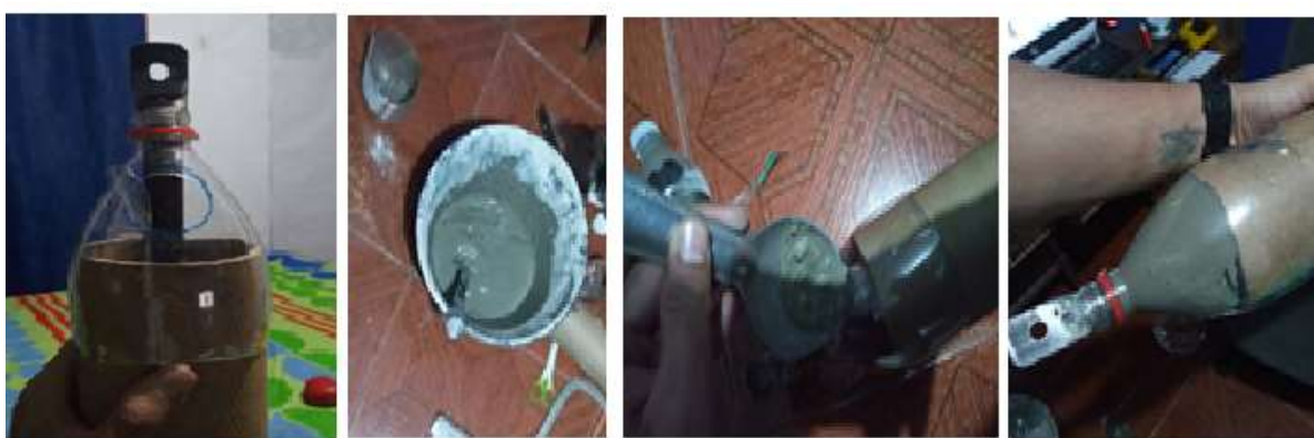
Figura 32. Fijación de la pieza de unión al extremo del cartón tubular. Elaboración propia.
