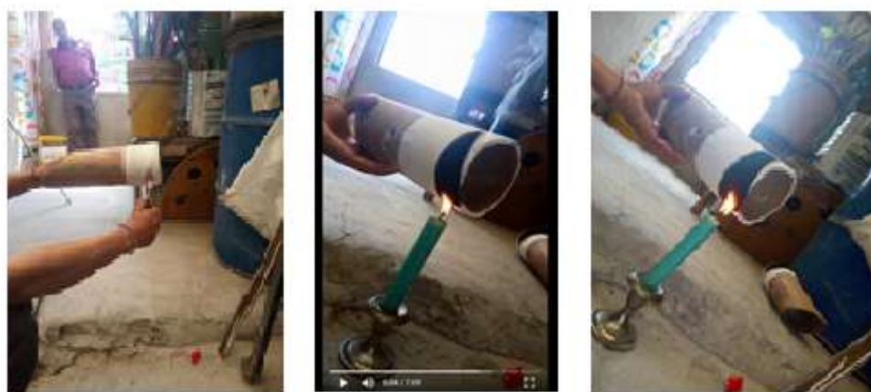
Figura 23. Prueba de resistencia al fuego al cubrir el tubo con yeso. Elaboración propia.
