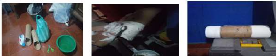
Figura 22. Prueba de resistencia al fuego al cubrir el tubo con silicona liquida. Elaboración propia.
