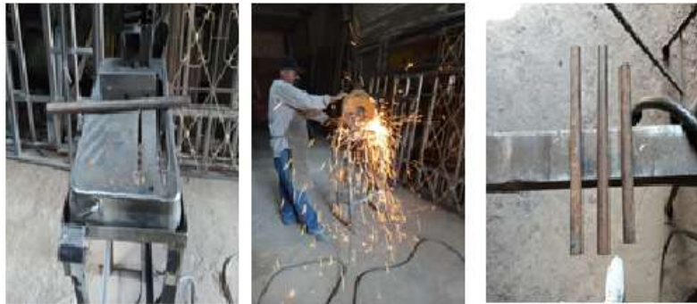
Figura 26. Corte de pieza de acero de cincuenta (50) centímetros. Elaboración propia.
