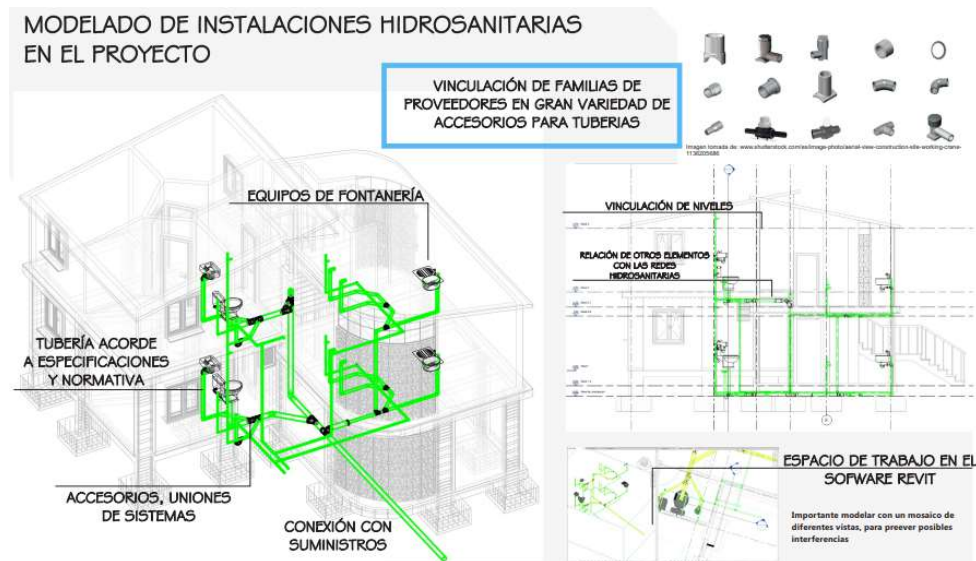
Figura 17 Modelado de instalaciones MEP 2
