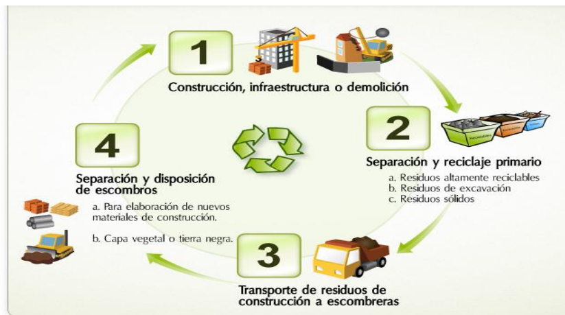
Figura 1. Ciclo óptimo de residuos de construcción y demolición
