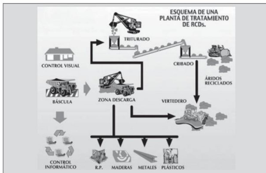
Figura 2. Esquema de una planta de tratamiento de RCD
