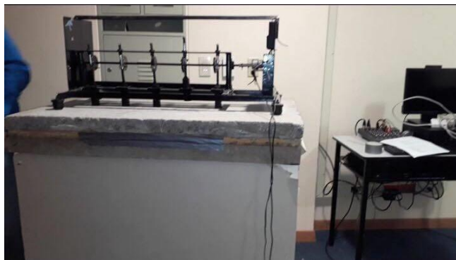
Ilustración 44: Ensayo a sistema esterilla guadua-concreto
