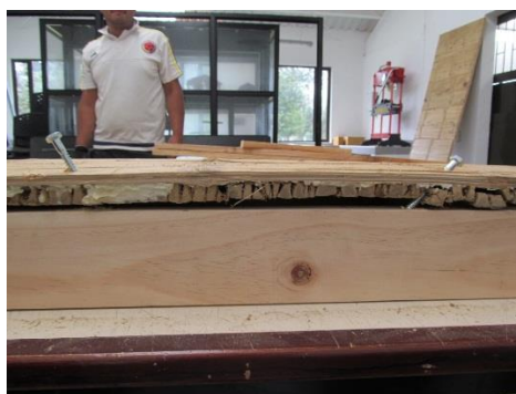
Ilustración 35: Conectores viga-guadua inclinados a 45°
