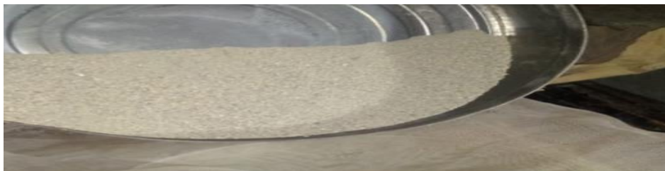
Figura 22 Cascarilla de huevo. La ilustración expone cascarilla de huevo tostada y molida. Elaboración propia.
