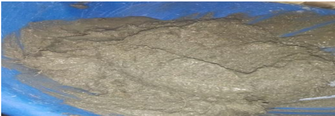
Figura 30 Mezcla de tierra para baldosa de piso. Mezcla de componentes para creación de baldosa de piso en tierra. Elaboración propia.
