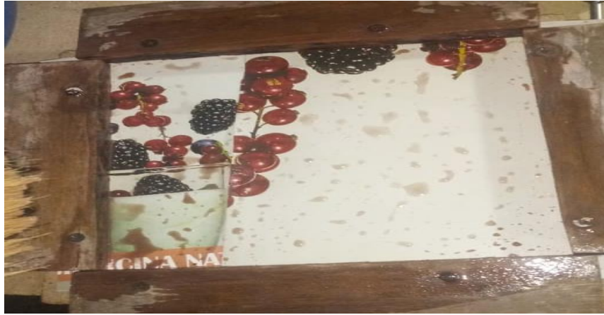
Figura 31 Molde para baldosa de piso. La ilustración expone un molde de madera elaborado artesanalmente para la mezcla de la baldosa. Elaboración propia.
