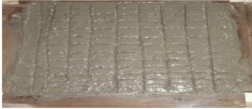
Figura 32 Parte trasera de la tableta en tierra. La figura expone la parte posterior para pegar al piso del prototipo baldosa a base de tierra. Elaboración propia.
