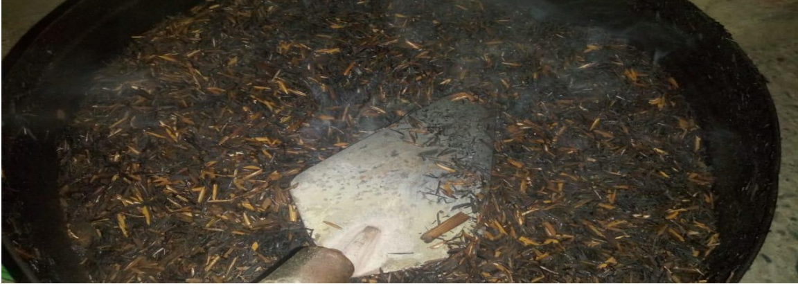
Figura 29 Cascarilla de arroz quemado. La ilustración muestra el proceso de creación de la ceniza de arroz para impermeabilizar la mezcla. Elaboración propia.
