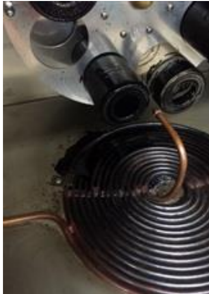
Figura 11. Prueba RTFO derrame del material
