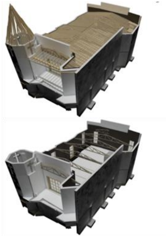
Figura 65 3D Estructura de cubierta, Elaboración propia
