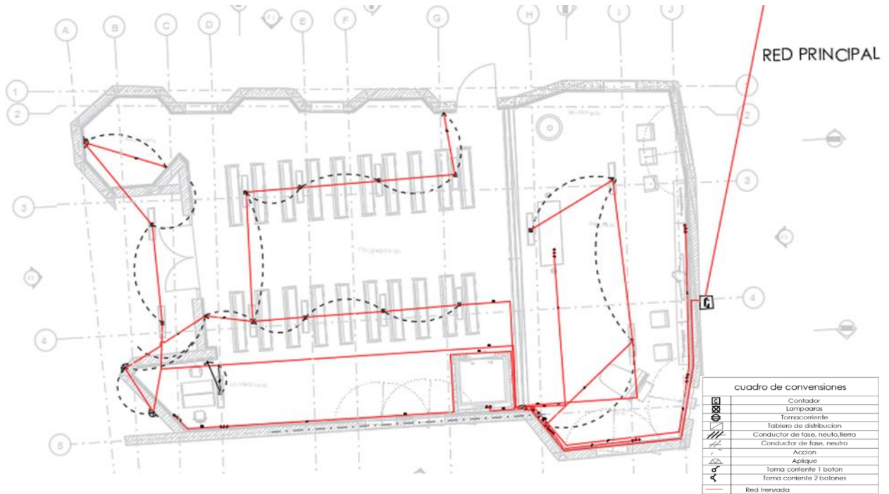
Figura 74 Red de alumbrado Templo parroquial San Roque, Elaboración propia
