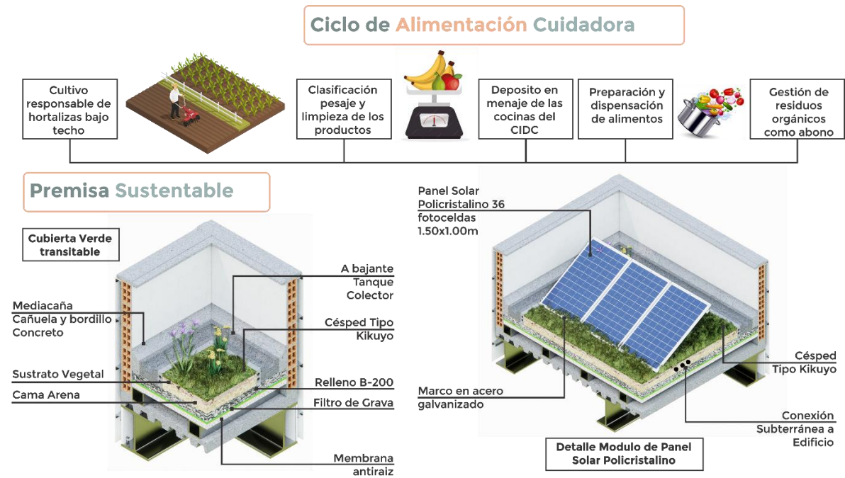
Figura 73. Cubierta verde y Paneles Solares. Fuente: Elaboración propia.
