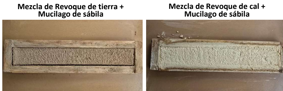
Figura 30 Probeta tipo B con recubrimiento – secado día 15
