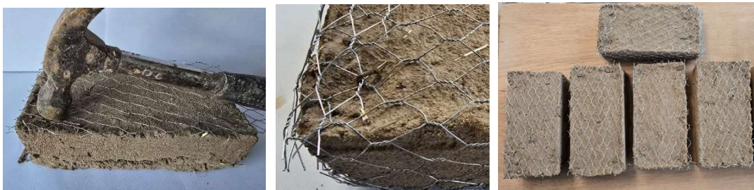
Figura 19 Colocación de malla en bloques de adobe
