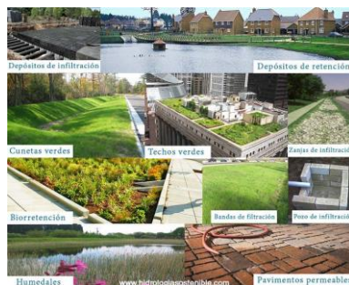
Figura 21. Tipos de retener y reutilizar el agua lluvia.
