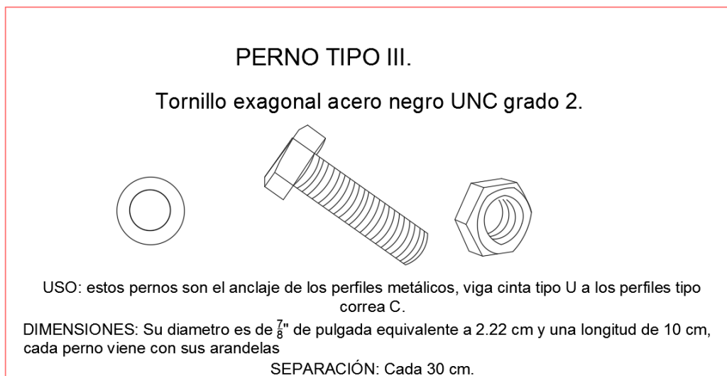
Figura 45 Perno anclaje de correas, Tipo III (UNC grado 2).
