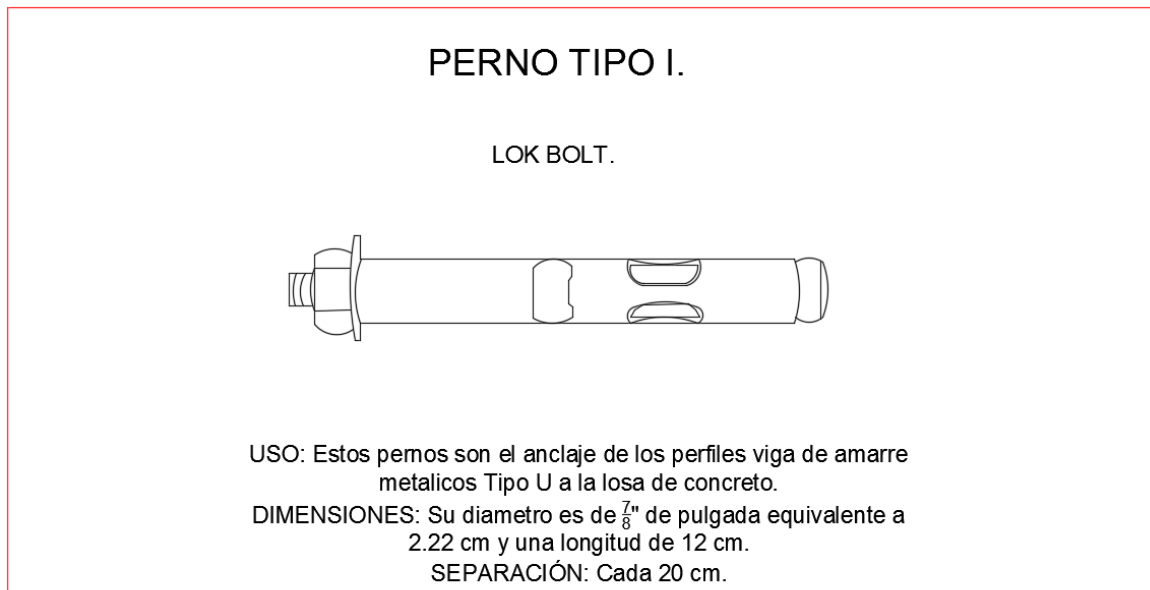
Figura 43 Perno para concreto, Tipo I (Lok Bolt.).
