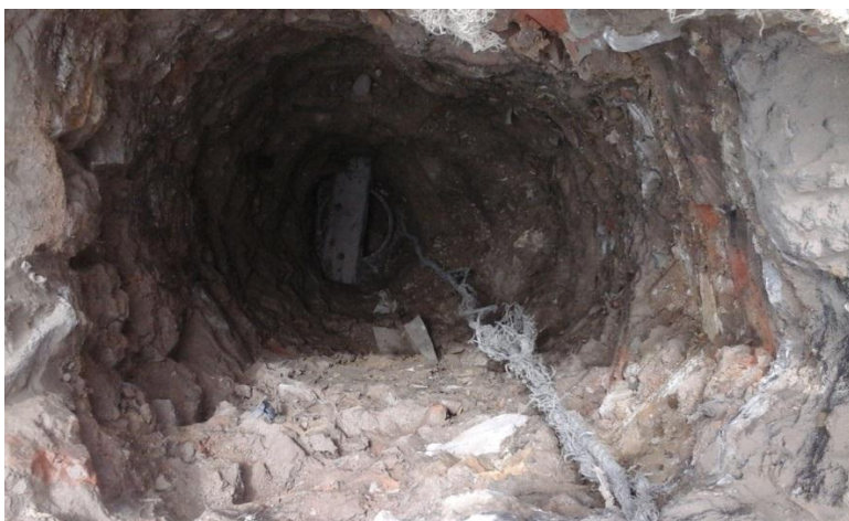
Fotografía 4 Extracción de muestra apique 1
