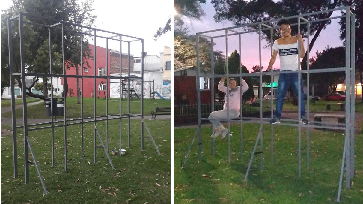
Figura 33. Prueba de resistencia y anclaje Fuente: elaboración propia
