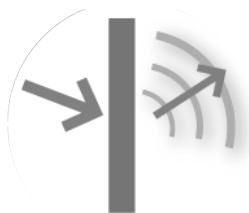
Figura 22. Transmisión de la onda sonora a través de un material. Elaboración propia.
