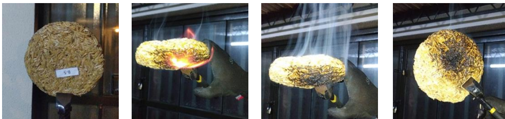
Figura 78. Realización prueba ignífuga a la probeta A-5. Elaboración propia.
