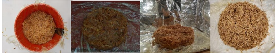
Figura 53. Proceso de mezcla por capas, desmolde, secado en cámara de calor y resultado final de una probeta.
