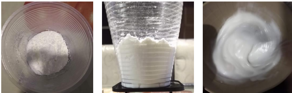
Figura 36. Almidón de maíz, presentación inicial y combinada con agua para producir el aglutinante. Elaboración propia.
