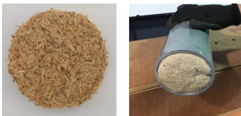
Figura 73. Probeta y medición en tubo de impedancia. Elaboración propia.
