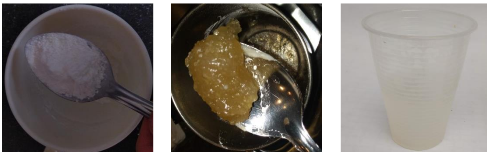
Figura 37. Almidón de yuca, presentación inicial y mezclada con agua para producir el aglutinante. Elaboración propia.
