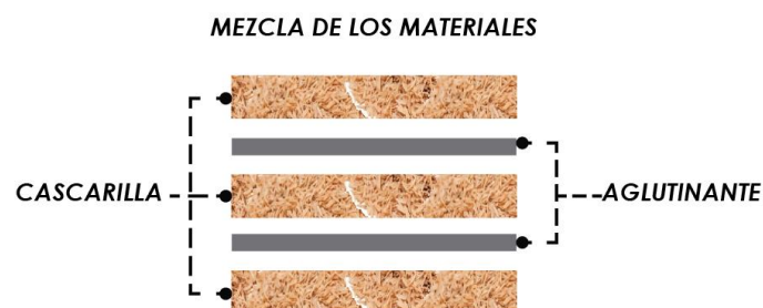
Figura 50. Mezcla de la cascarilla junto con el aglutinante. Elaboración propia.
