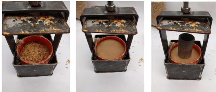
Figura 52. Proceso de mezcla de los materiales y posterior colocación en la prensa y el molde. Elaboración propia.
