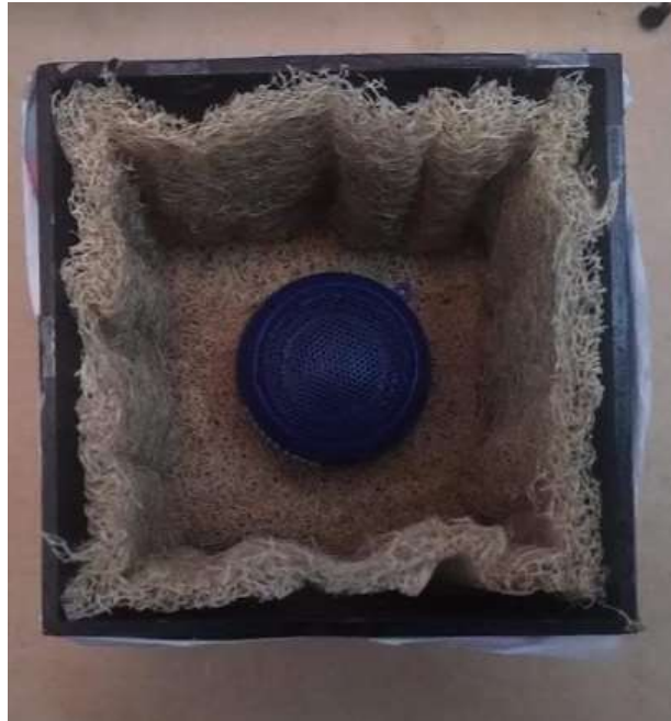
Figura 39 Caja con paneles de Luffa Cylindrica y la fuente sonora Elaboración Propia
