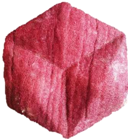
Figura 18 Muestra obtenida de luffa compactada con fécula de Maíz Elaboración propia
