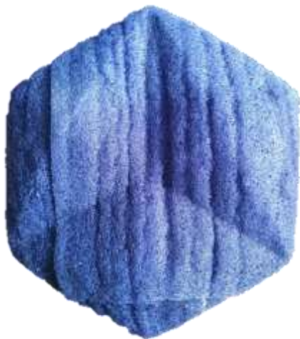
Figura 20 Muestra obtenida de luffa compactada con Carpinol Elaboración propia.
