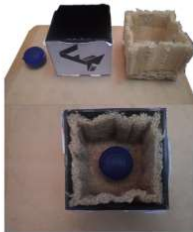
Figura 26 Caja adecuada para prueba de transmisión de sonido Elaboración propia
