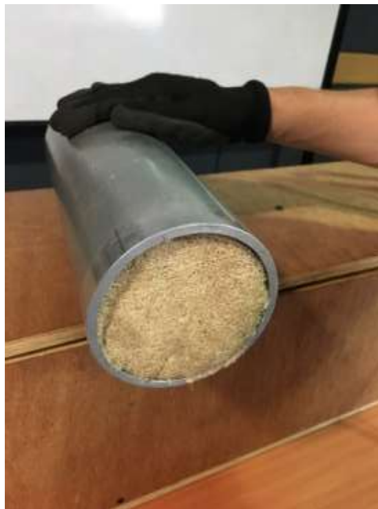
Figura 28 Ubicación de la probeta en tubo de impedancia Elaboración propia
