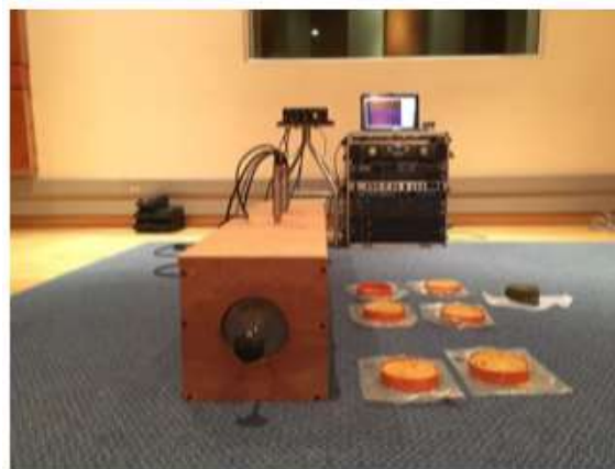
Figura 29 Ejecución de ensayos en el tubo de Impedancia Fuente: Propia
