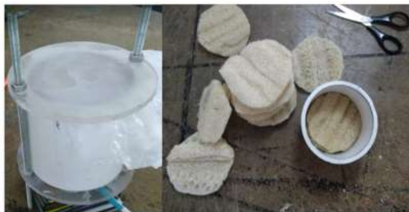
Figura 24. Proceso de compactación de probetas Elaboración propia
