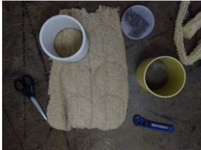
Figura 23. Corte diámetro de 4" para tubo de impedancia Elaboración propia
