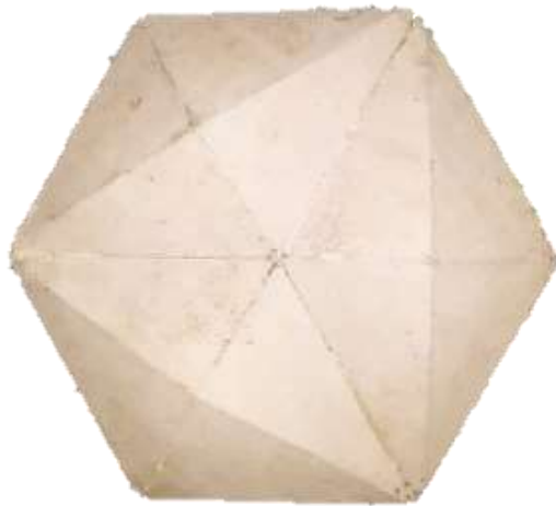
Figura 21 Muestra obtenida de luffa compactada con Cemento blanco Elaboración propia
