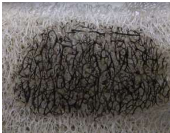
Figura 41 Luffa expuesta al fuego Elaboración Propia.
