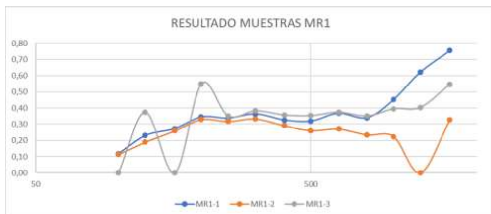
Figura 34 Gráfica de picos obtenidos por las 10 muestras MR1 obtenidas en el tubo de impedancia Elaboración Propia
