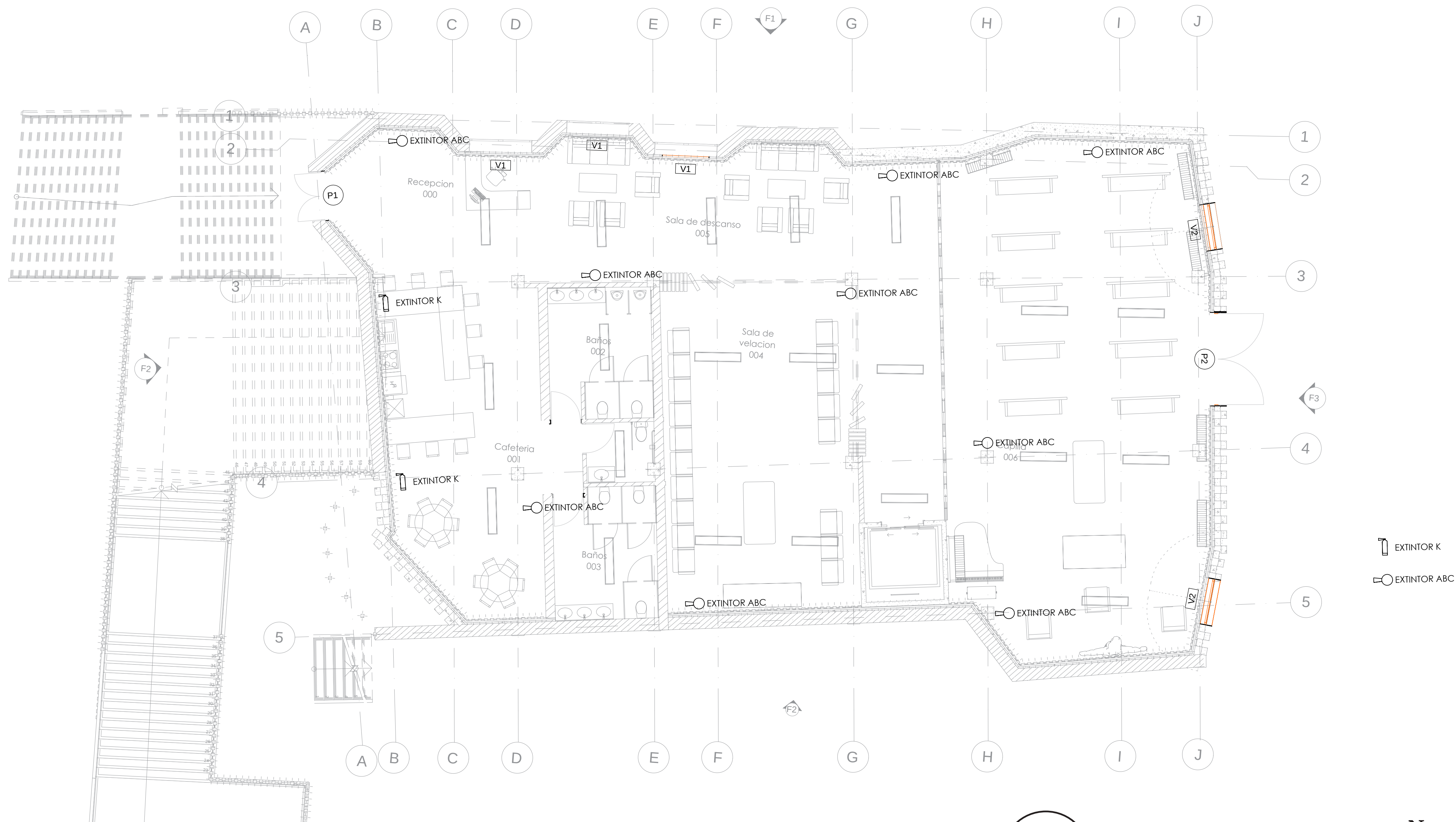
E25 PLANO EXTINTORES PLANTA BAJA Esc: 1:100
