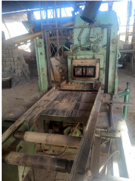
Figura 4. Extrusión de arcilla cruda para la elaboración del ladrillo.
