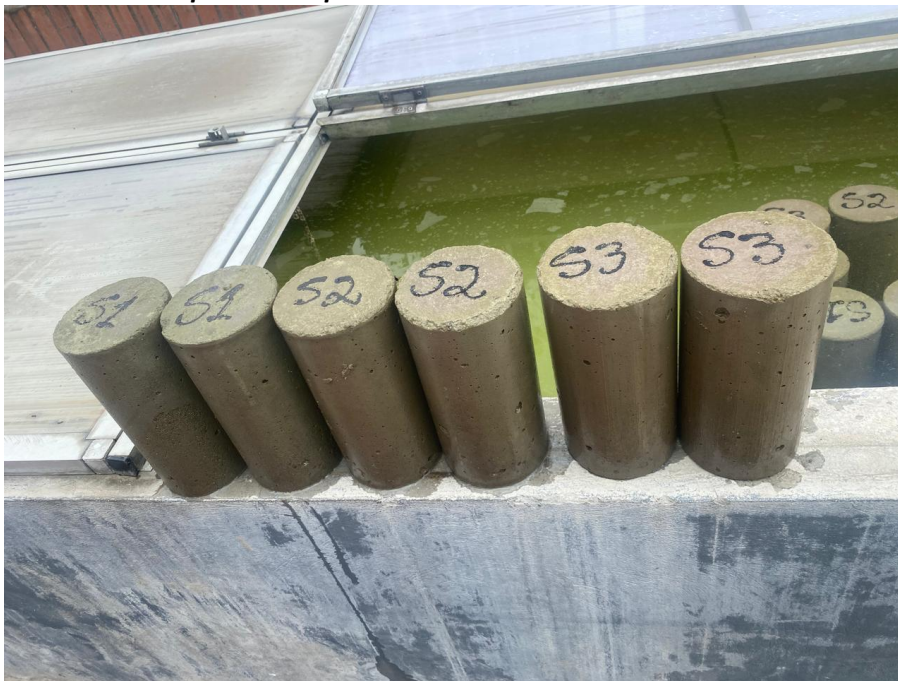
Figura 26. Muestras de concreto después de su periodo de curado.
