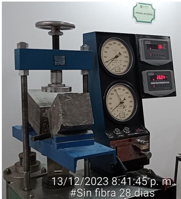
Figure 26 rotura de viga sin fibra
