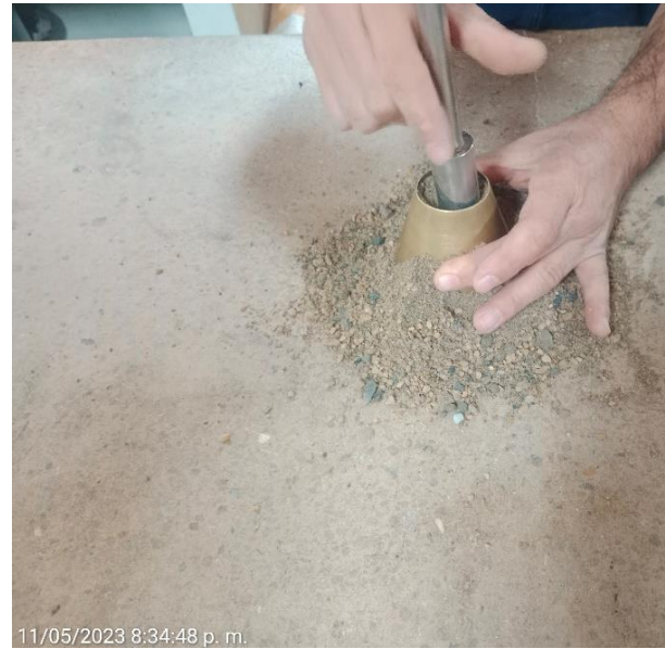
Figure 12: Comprobación de Humedad de Muestra-Fuente Propia
