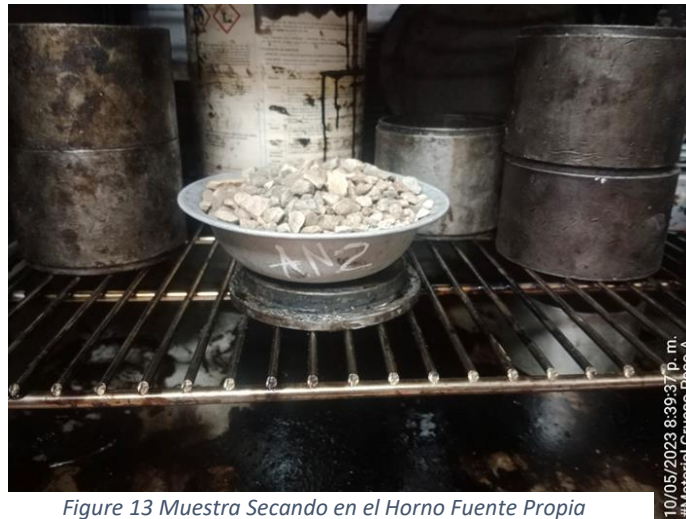
Figure 13 Muestra Secando en el Horno Fuente Propia
