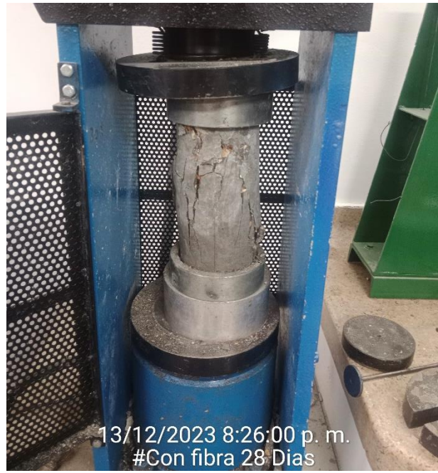
Figure 24 Rotura de cilindro con fibra
