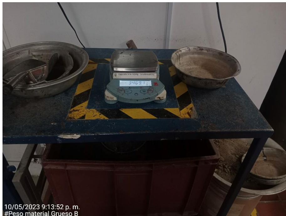
Figure 14 Determinación de Masa Aparente en agua
