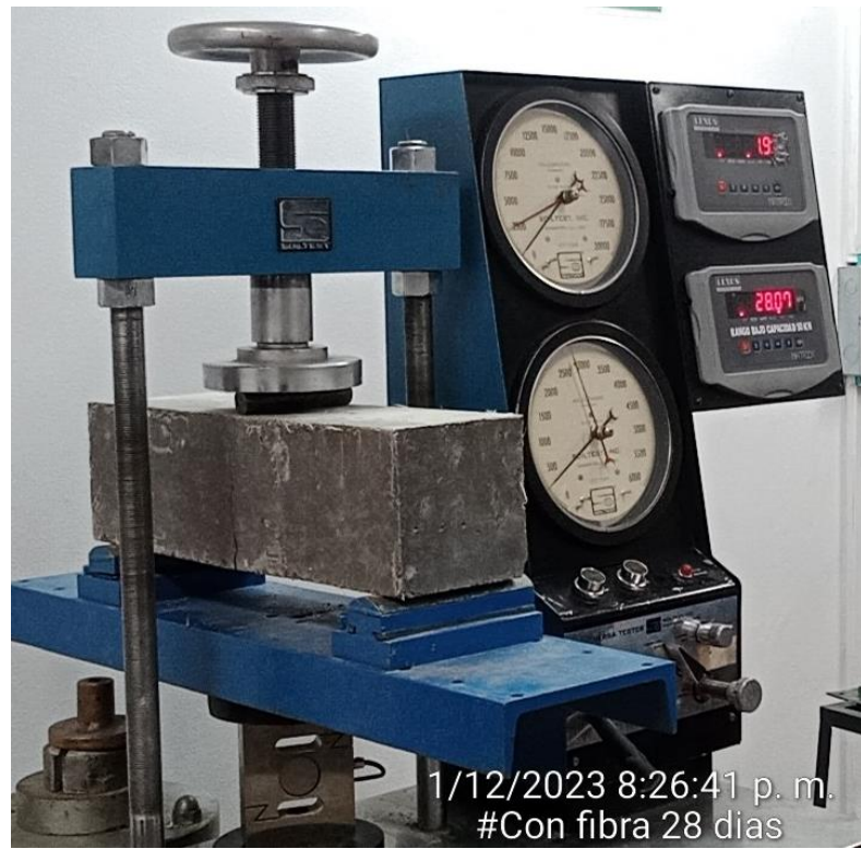
Figure 30 Rotura de viga con fibra fuente propia
