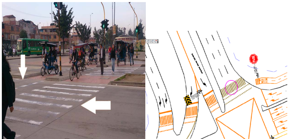
IMAGEN 25 Señalización acceso Portal Américas
