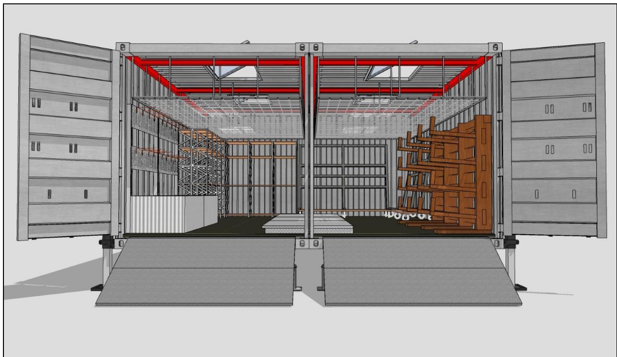
Ilustración 36 Vista frontal en representación 3D de mobiliario instalado en los contenedores adaptados para almacenamiento de materiales en obra con su respectiva rampa como elemento de entrada. Elaboración propia
