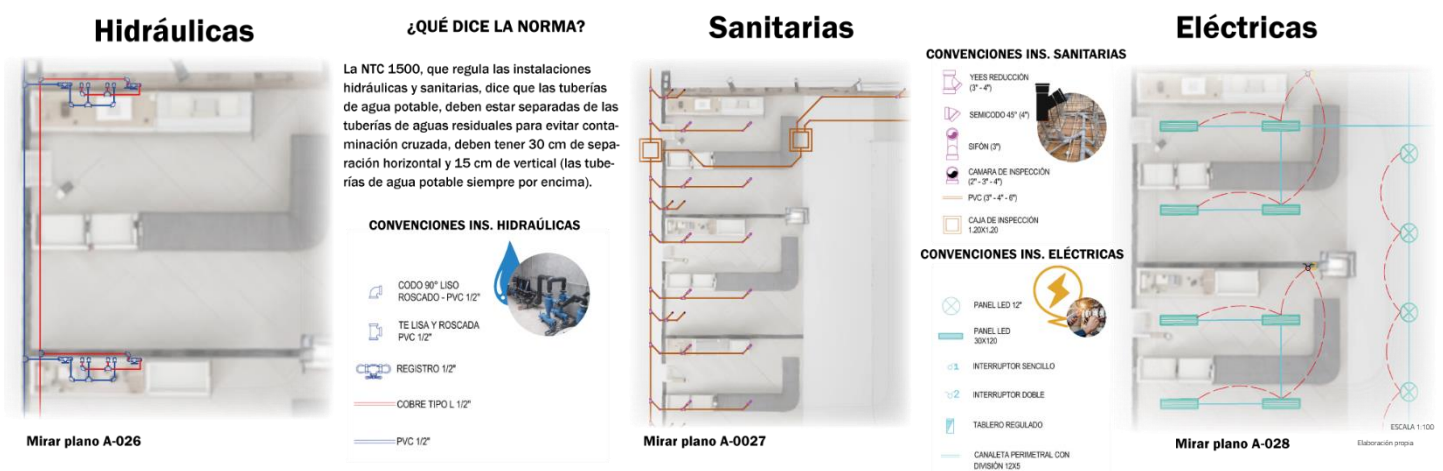
Figura 47 Instalaciones hidrosanitarias y eléctricas
