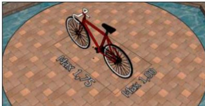
Dimensiones de una bicicleta dentro del parámetro de diseño PMC. Fuente Freddy Giovanni Calderón Moreno
