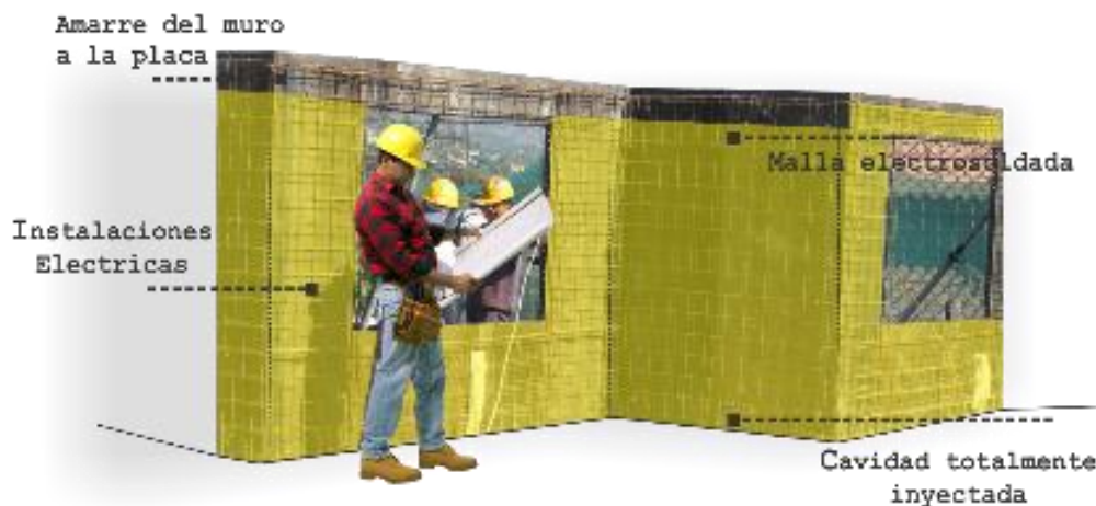
Figura 76: instalación de los muros de poliuretano
