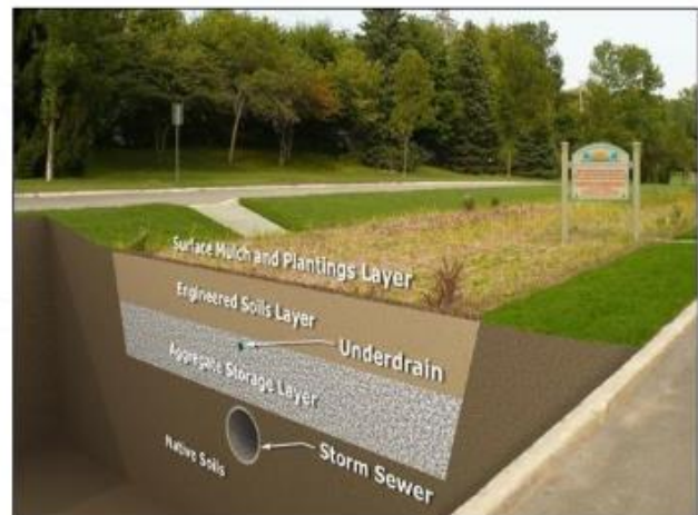
Imagen 12 Dren filtrante con capas granulares Fuente: lineamientos del componente paisajístico EAAB
