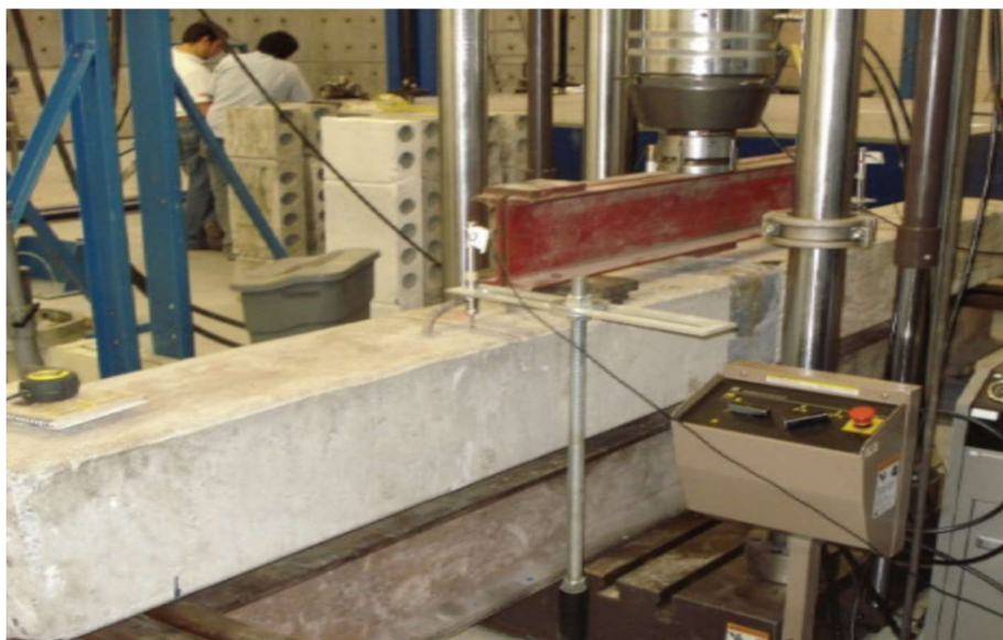
Fuente: Tomada por los autores Colpatria Torres De Santa Lucia I Bogotá 2010 Ensayo A Flexión
