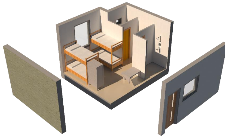
Figura 91. Celda compartida para condenados con zona húmeda interna – Elaboración propia
