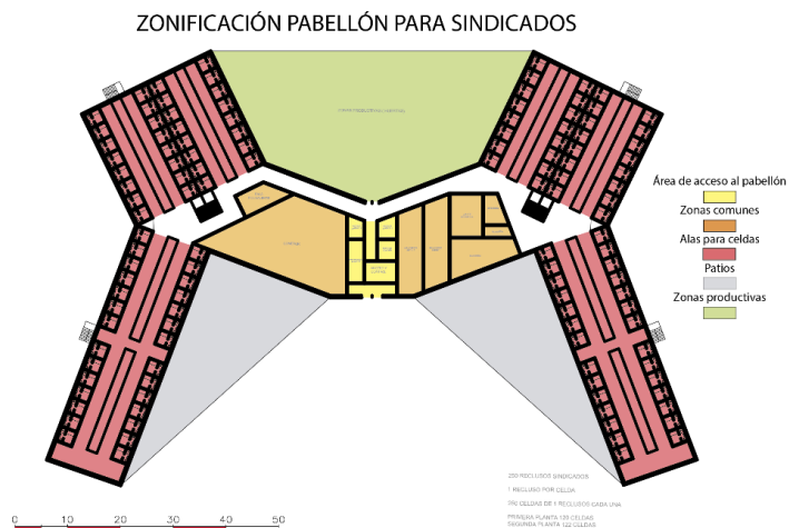
Figura 76. Zonificación pabellón sindicatos – Elaboración propia
