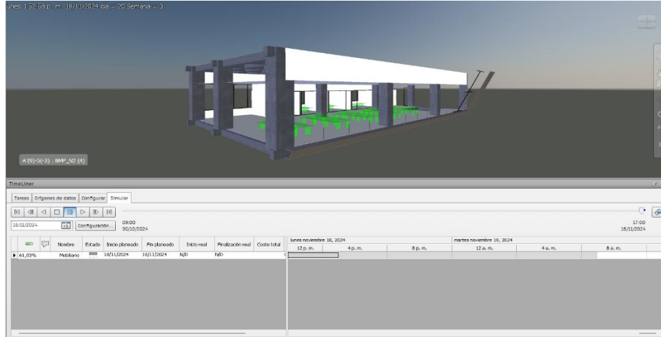
Figura 33 Simulación de actividades constructivas Navisworks.
