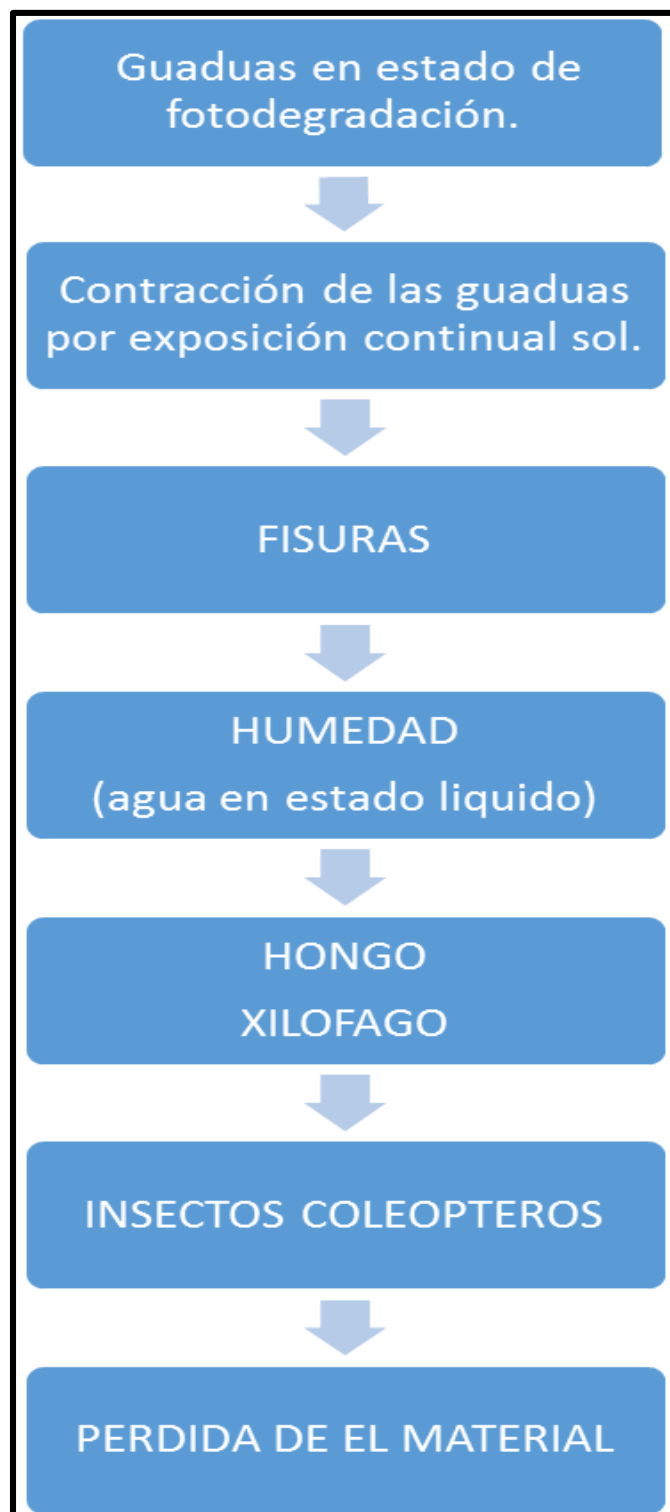
Figura 23. Análisis Fotodegradación en la Guadua.
